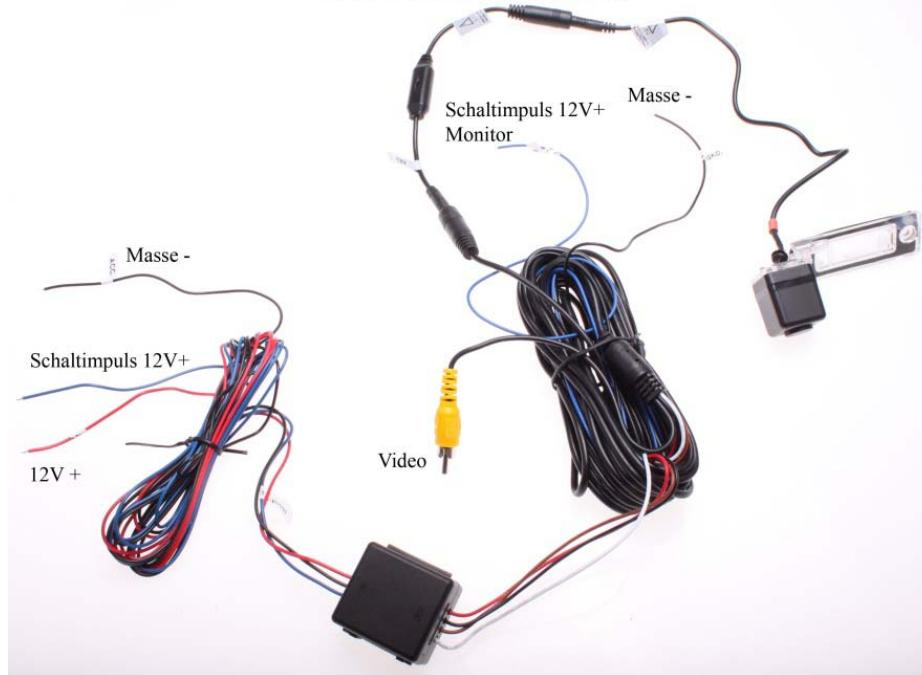
**rot:** +12V Spannung für die Rückfahrkamera (Klemme 15 / Zündung abgreifen)
