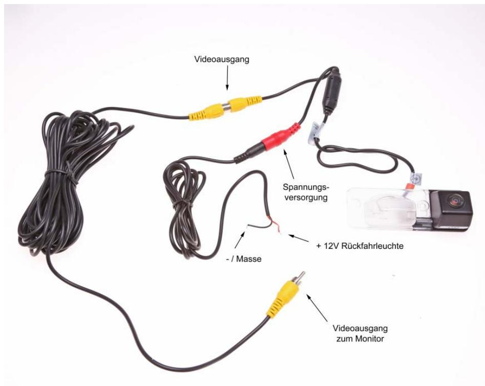
Die Kamera verfügt für die Spannungsversorgung über einen Niedervoltstecker, ein Adapterkabel auf offene Kabel +/- ist im Lieferumfang enthalten.
