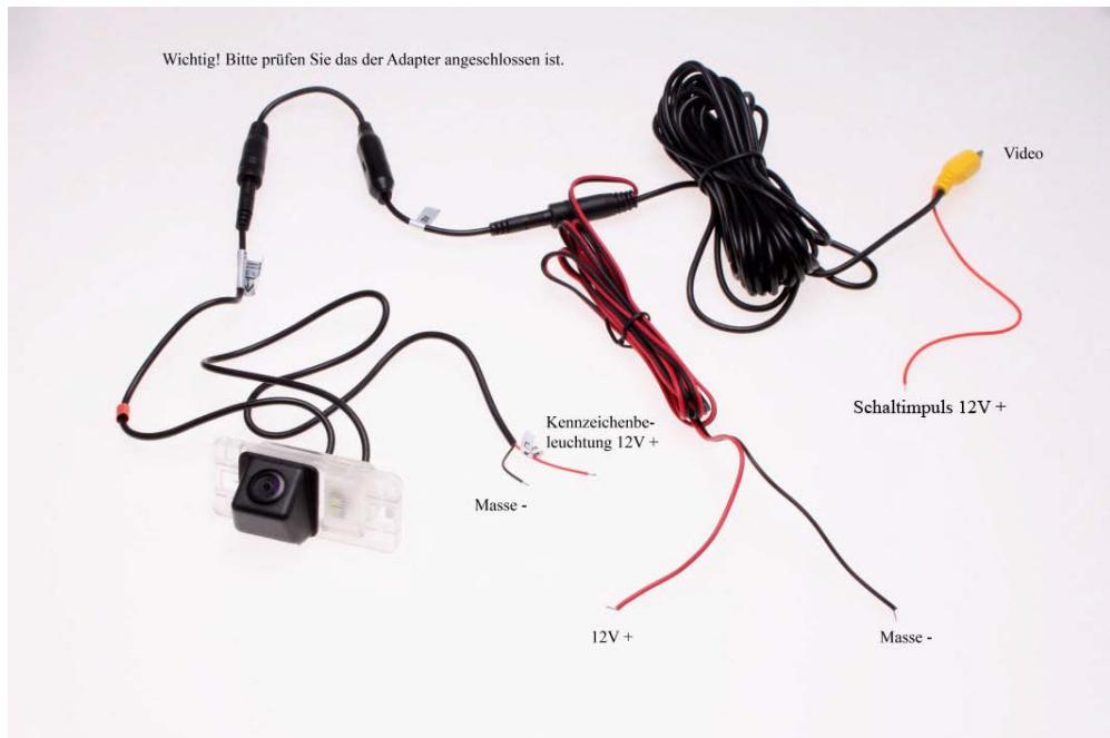
**rot:** +12V Spannung für die Rückfahrkamera (von der Rückfahrleuchte abgreifen)
